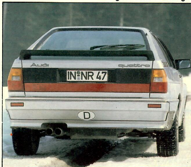
Das Heck wirkt durch den Spoiler extrem hoch; der Heckwischer und -wascher kostet 281 Mark Aufpreis
