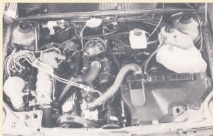
Turbo-Kraft: Der aufgeladene 2,2-Liter-Motor bringt 200 PS
